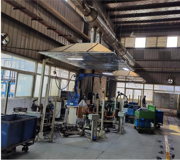
机器人二保焊废气集气罩
